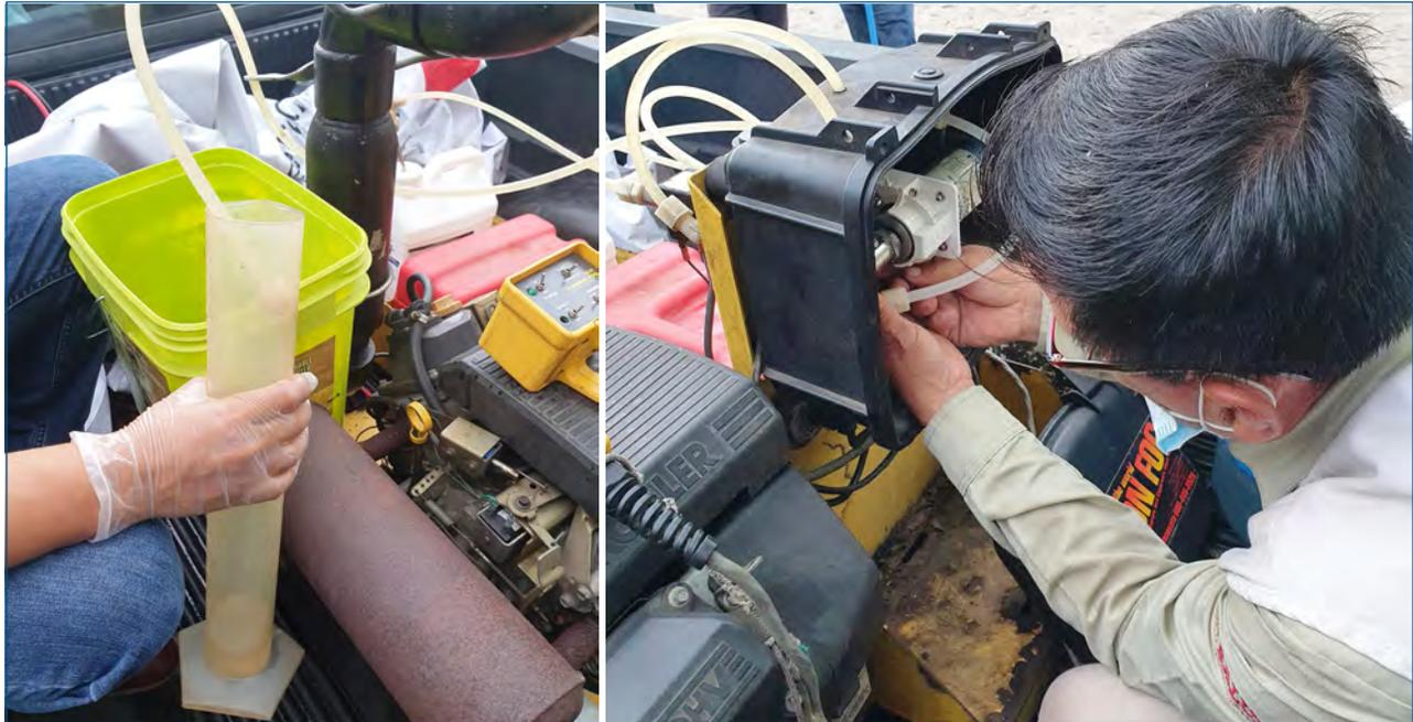
Foto 005 Calibración de la tasa de descarga del producto.
