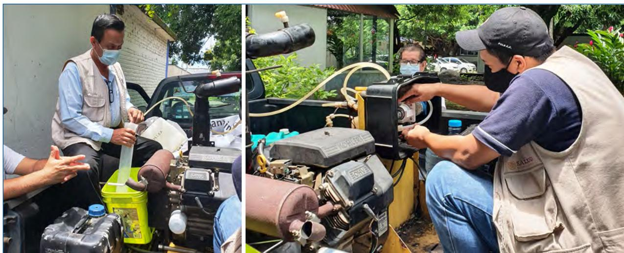
Foto 030-2 Encendido de la bomba de succión y descarga de la mezcla por 1 minuto.
