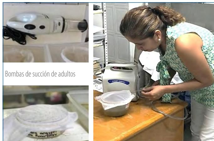
Figura 6 Método para manejar adultos mediante bomba de succión.
