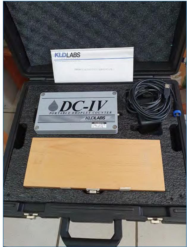
Foto 002 Equipo DC-IV (KDLABS Incorporated) para calibrar el tamaño de gota.
