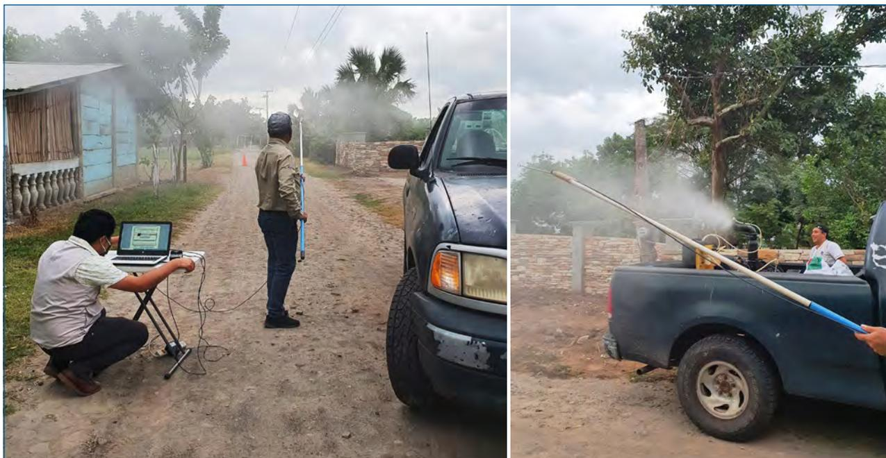
Foto 004 Calibración del tamaño de gota.
