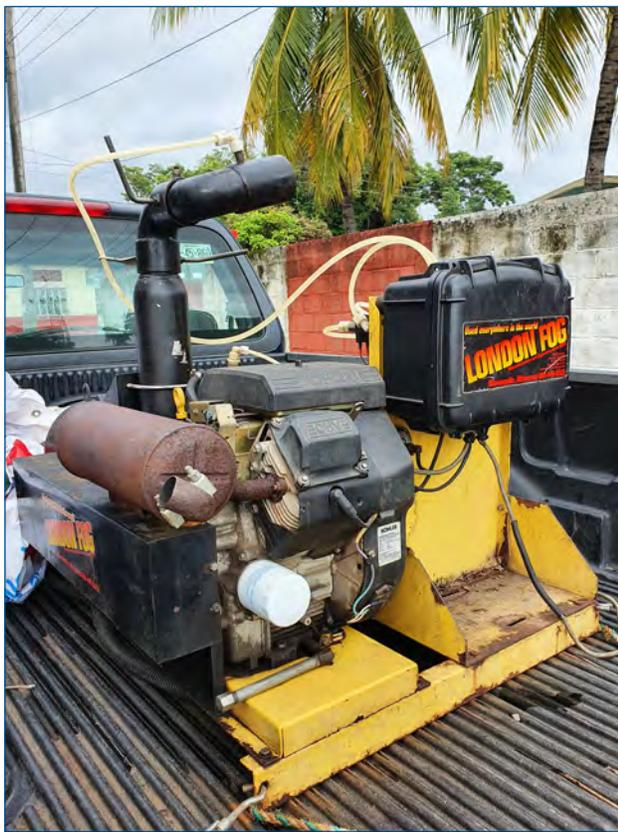
Foto 001 Equipo pesado (HP) generador de nieblas frías a Volumen Ultra Bajo (UBV).
