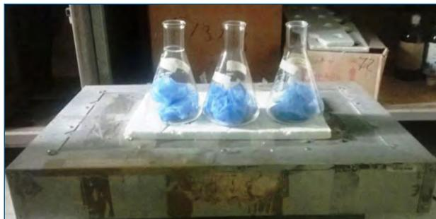
Foto 025 Lavado de muestras de mosquiteros de cama en un aparato agitador.
