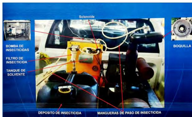
Foto 029-2 Sistema de descarga de insecticida.
