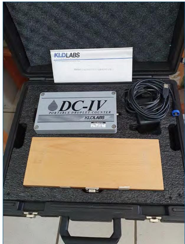
Foto 002 Equipo DC-IV (KLDLABS Incorporated) para calibrar el tamaño de gota.
