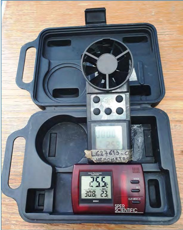
Foto 003 Anemómetro y termohigrómetro.
