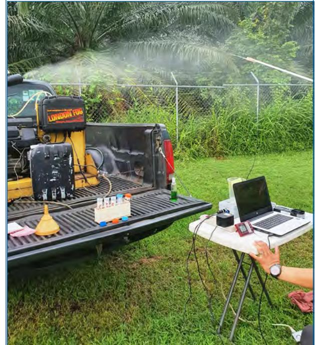
Foto 032-1 Encendido de máquina pesada. Exposición del vástago dentro de la nube de insecticida por 30 segundos.
