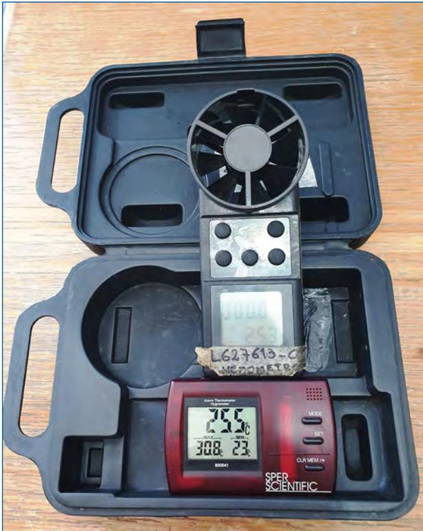
Foto 003 Anemómetro y termohigrómetro.
