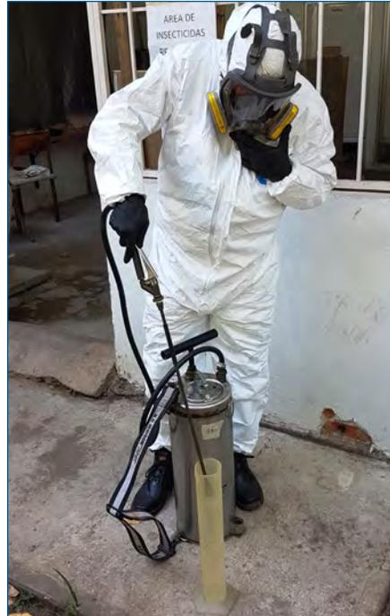
Foto 019 Calibración con mezcla de insecticida.
