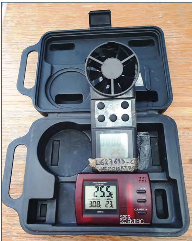
Foto 003 Anemómetro y termohigrómetro.
